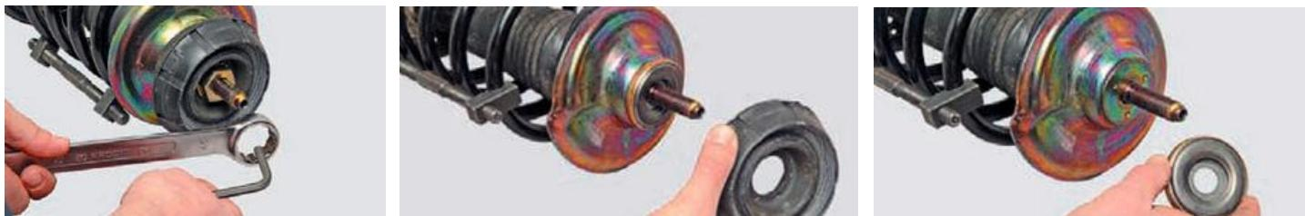
На снятой стойке стягиваем пружину и накидным ключом на 27 отворачиваем гайку крепления верхней опоры, удерживая шток от проворачивания шестигранником на 6. Снимаем опору стойки и подшипник опоры.
