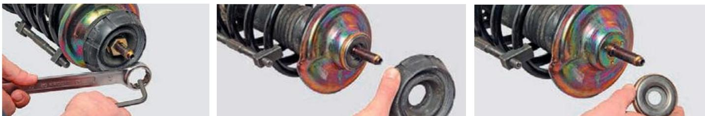
На снятой стойке стягиваем пружину и накидным ключом на 27 отворачиваем гайку крепления верхней опоры, удерживая шток от проворачивания шестигранником на 6. Снимаем опору стойки и подшипник опоры. Порядок сборки амортизаторной стойки.
