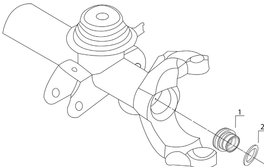
1. Стакан кожуха полуоси с полиуретановым упругим элементом;
