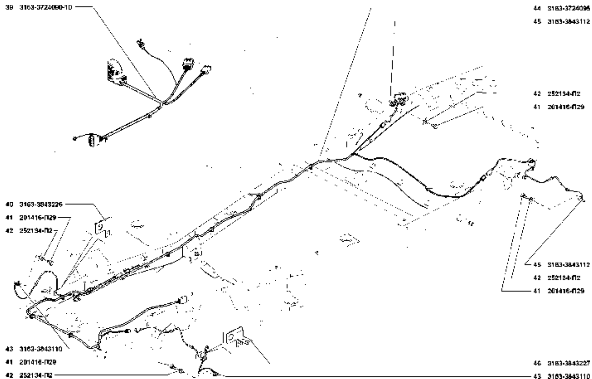
Рис. 85. Электропровода (3724)/5 Fig. 85. Wires (3724)/5
