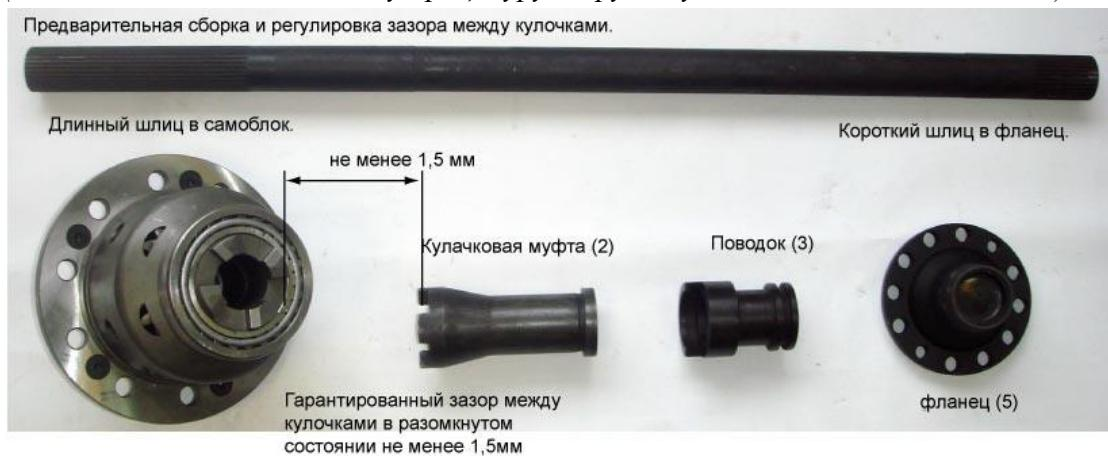
**Установка в передний мост.** Похожая процедура, за исключением: устанавливается короткая полуось (4) ВАЛ-РЕЙСИНГ и через соединительную муфту ВАЛ-РЕЙСИНГ (5) устанавливается короткий серийный или любой другой ШРУС (взамен длинного).
