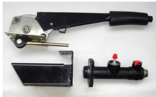
2. Установить на кронштейн (6) главный цилиндр (12) закрепив его двумя болтами М6х25(25) и гайками М6 (26) (*Сильно не затягивать, окончательная затяжка гаек после позиционирования и установки штока в цилиндр.*)
