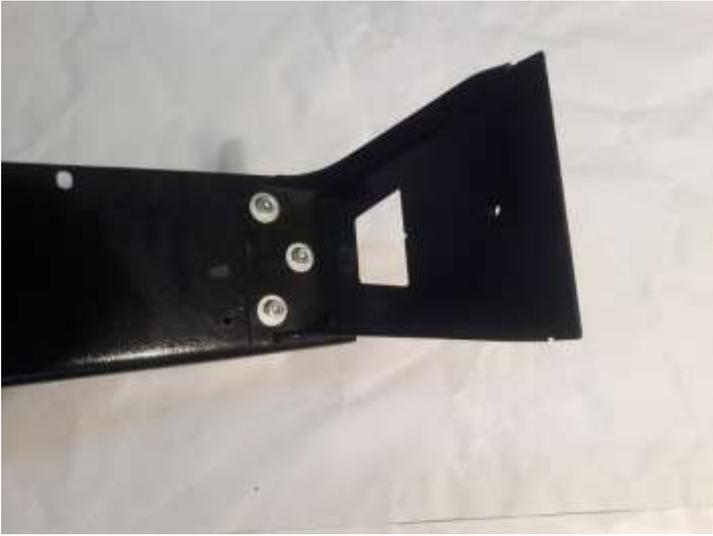
1. Крепим опорные кронштейны с обеих сторон к коробу посредством трёх болтов каждый. Привести в габарит расстояние между опорными кронштейнами. Внешний габарит : УАЗ 469-1535мм, УАЗ 452-1720мм, УАЗ Патриот -1230мм.
