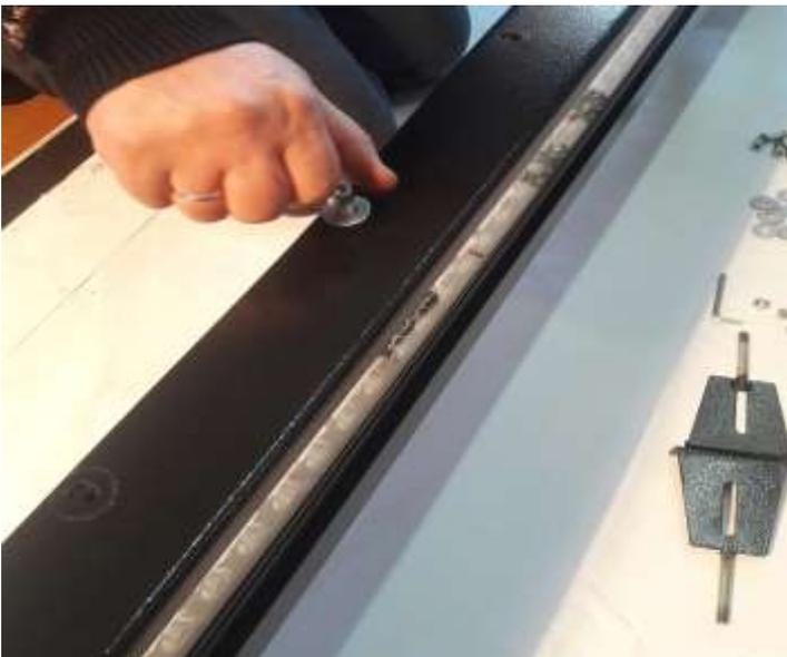
3. Частично погружаем заднюю крышку, оснащенную закладными гайками, в корпус короба. Наживляем один из болтов.
