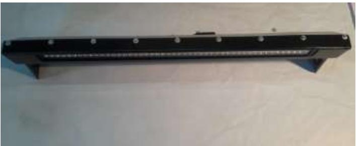
4. Выравниваем заднюю крышку, полностью закрепляем верхнюю часть. Закрепляем нижнюю часть. Изделие готово к установке на автомобиль.
