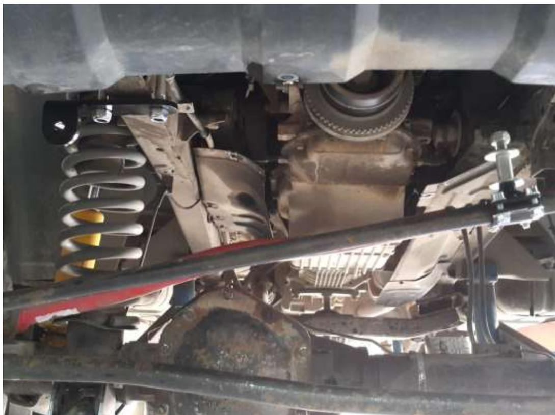
3. Перед установкой рулевой демпфер необходимо прокачать, несколько раз сжать, а затем разжать. Для установки необходимо выставить расстояние между осями демпфера 610-620 мм, колёса автомобиля при этом должны располагаться прямолинейно.
