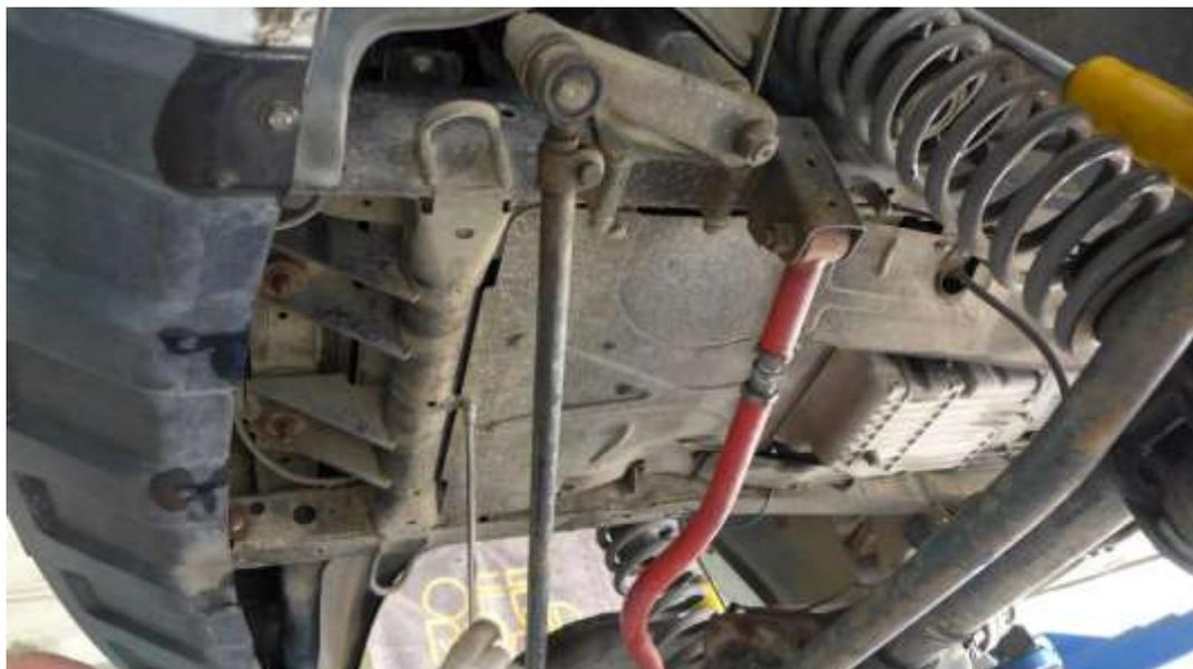
В некоторых случаях удаётся установить трубку без доработки защиты. Установить кронштейн-уголок на правую сторону рамы автомобиля с помощью трубки. Ухо должно располагаться снаружи рамы автомобиля и быть развёрнуто вниз. Гайки трубки затягивать после окончательной установки.
