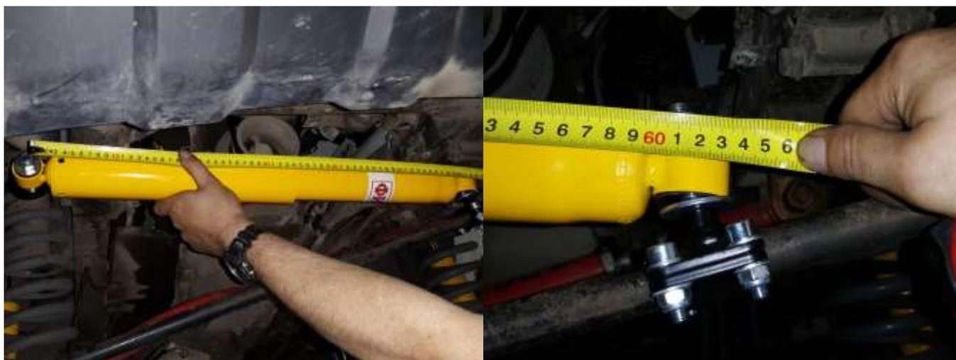
4. Демпфер должен располагаться непосредственно над рулевой тягой, вдоль неё. Кожух демпфера должен быть расположен на кронштейне рамы.
