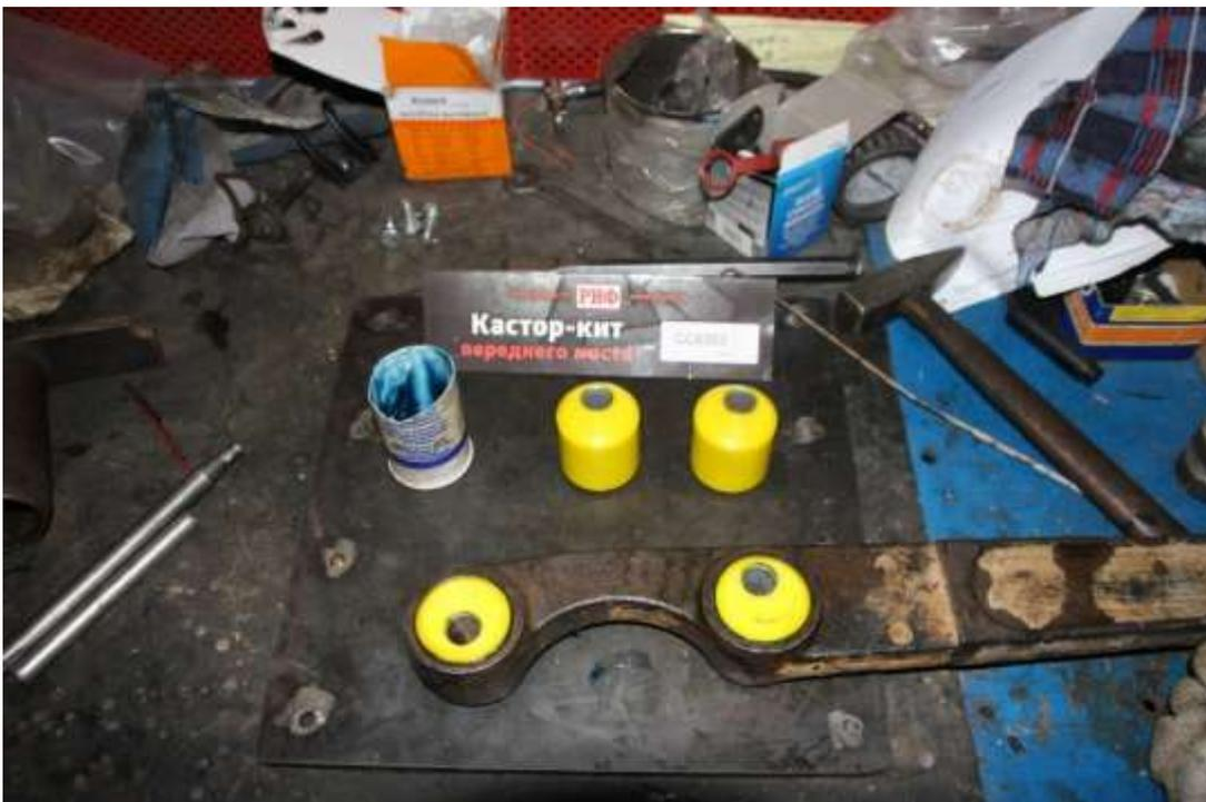
Так как рычаг изменит положение относительно моста, необходимо снять фаску на крепеже моста над задней втулкой, шириной примерно 1 см.
