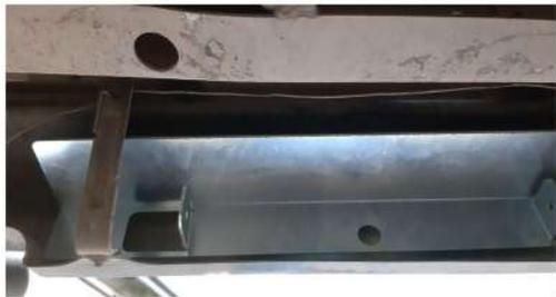
2. Установите лонжероны усилителя на раму.
