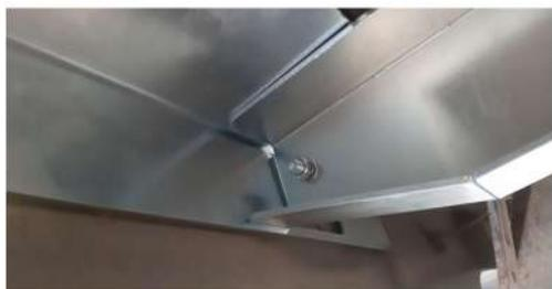
4. Зафиксируйте болтом М14 лонжероны усилителя на раме.
